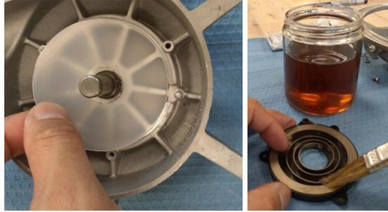
3. Alinee el bucle de retención del muelle con el poste de la carcasa e instale el muelle en la carcasa.
