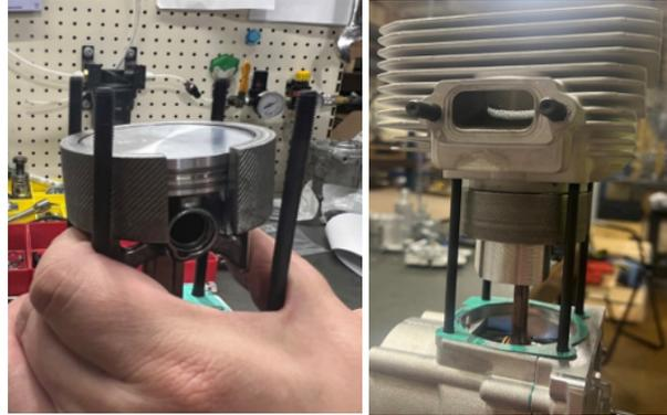
53. Aplique sellador de juntas de cobre (p. ej.: Permatex Copper Spray-A-Gasket High-Temperature Sealant) a ambos lados de la junta de culata e instálela sobre los espárragos.
