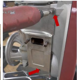
3. Instale la segunda junta del escape en el deflector de escape. Asegúrese de que la “**protuberancia**” esté orientada hacia fuera, hacia el escape.
