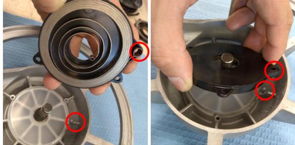
5. Coloque la guía del cable en la carcasa.
