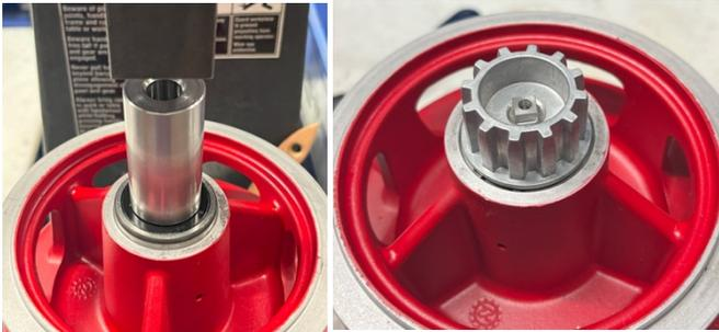
8. Coloque el extremo de la bomba en el soporte de montaje 701860.
