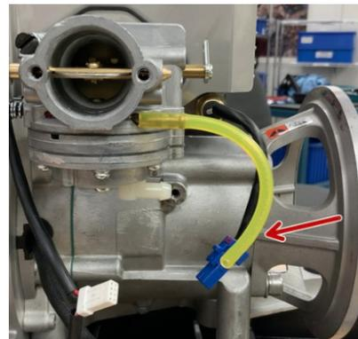
El tubo Tygon tiene una curvatura natural. Para ayudar a evitar que se doblen, preinstale el tubo Tygon **corto** en la **púa larga** del bulbo de purga con la curva apuntando **hacia abajo**. Preinstale el tubo Tygon largo en el codo del puerto de purga del carburador con la curva apuntando **hacia abajo**.
