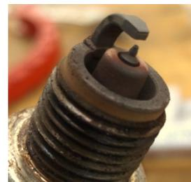
El color tostado en ambos electrodos indica un ajuste correcto del carburador.
