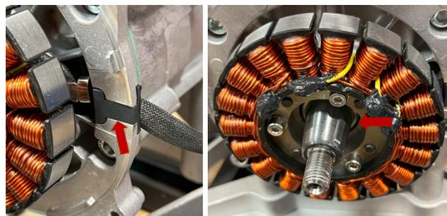
instala la chaveta, la sincronización del encendido será incorrecta.
