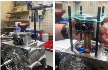
46. Instale la junta de la base. Tenga cuidado de no dañar la junta durante la instalación. **Asegúrese de que el orificio de pulso esté correctamente alineado.**
