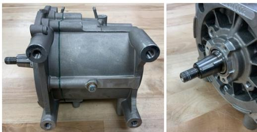
38. Lubrique los cojinetes del cigüeñal, las carrilleras del cigüeñal y el cojinete de la biela con el aceite de motor 10W40.
