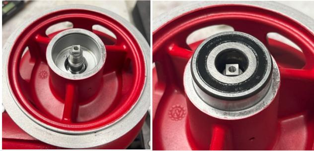
5. Alinee la herramienta de presión del cojinete 701862 con el anillo interior del cojinete y presione el cojinete hasta el fondo.
