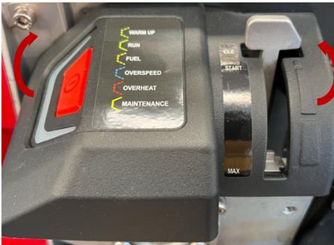
6. Retire los tres tornillos que sujetan la carcasa del sistema electrónico a la unidad.
