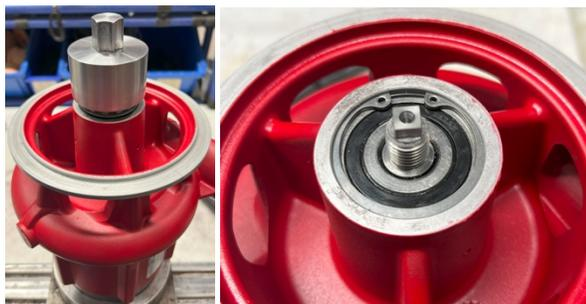
10. Coloque la bomba boca abajo sobre el soporte de desmontaje 702113.
