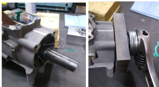
26. Aplique **Loctite 243** en las roscas de los cinco tornillos del cárter.
